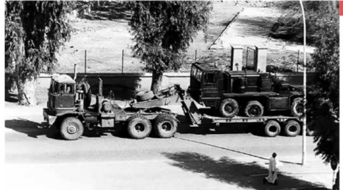
Marokaanse M746 met een lekke band wordt vervoerd door een Mack F897ST met M747 oplegger. Deze Mack is ooit ook getest als tanktransporter voor het Amerikaanse leger maar werd niet gekozen.
