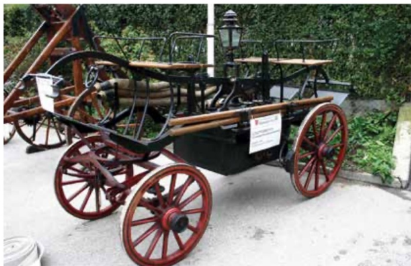
Een hand bediend brandblusapparaat van de firma Feuerlöschgerätefabrik uit 1903. Later ging deze firma op in FAUN. Vermogen van deze pomp: 1200 ltr/min.
