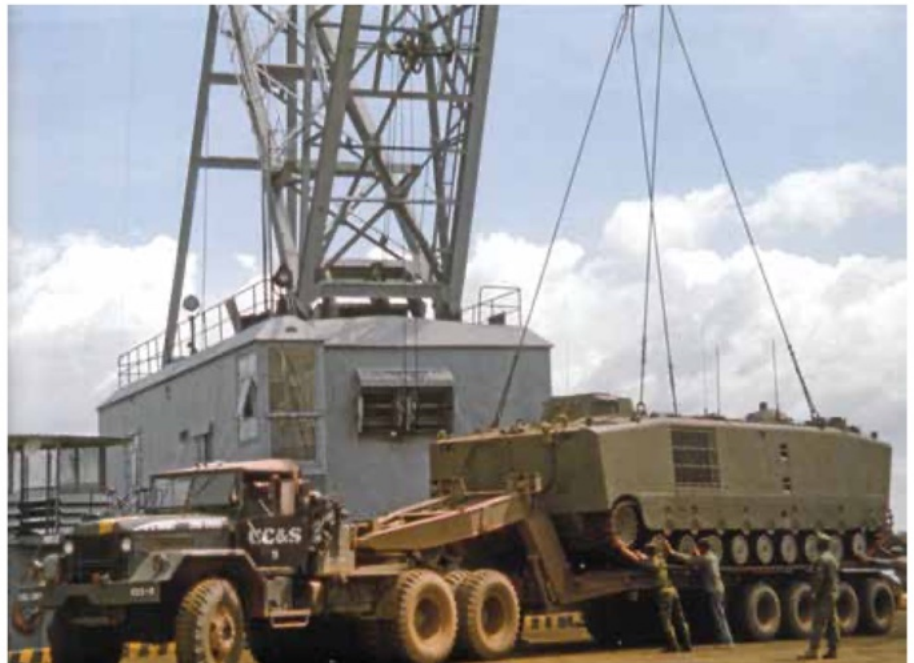
M747 oplegger, getrokken door een Mack M123, wordt in Vietnam beladen met een LVTP-5.
